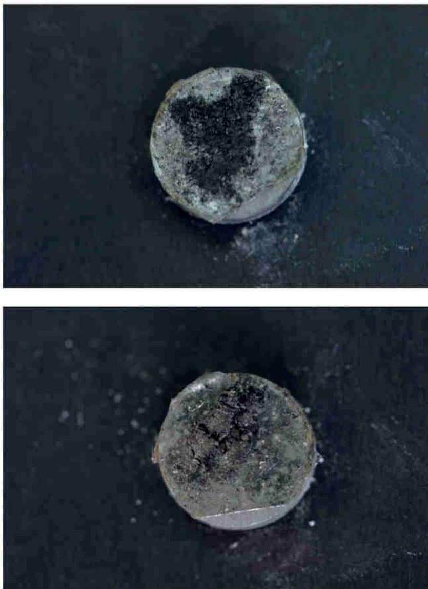
Fig. 11 – Supporti con frammenti tessili metallizzati pronti per l'osservazione al SEM (reperto 18069/B).
